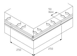
**WELDED CORNER FABRICATION**
